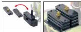
0778 55 Claas Ballast-Gewichte Xerion Flexible Ballastierung
