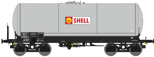
Réf. WB-317 - Wagon Citerne ANF Ep.III "SHELL" W018-C-01 - Citerne courte, bogie Y 23M boîtes SKF, N° SCywf 595483
